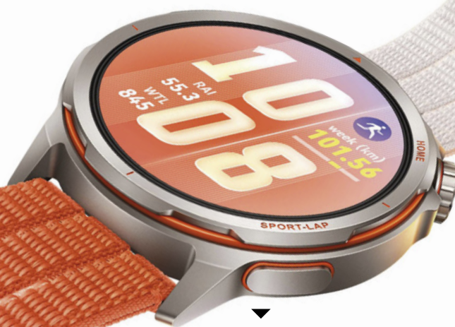
De kast van de Huawei Watch GT Runner 2 is gemaakt van een titaniumlegering.
